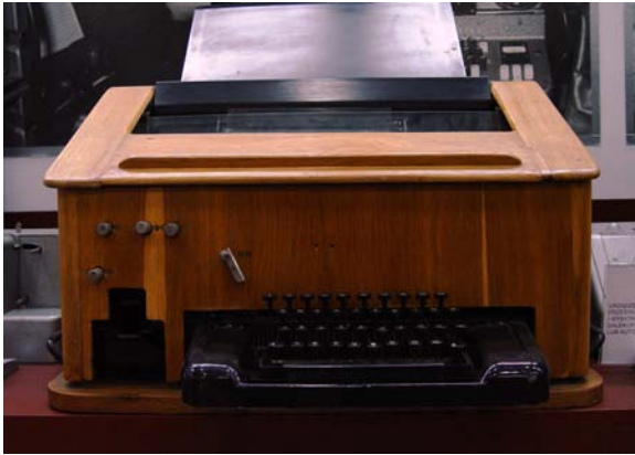
Aparat telegraficzny „MORSE”; służył do zapewnienia łączności telegraficznej
