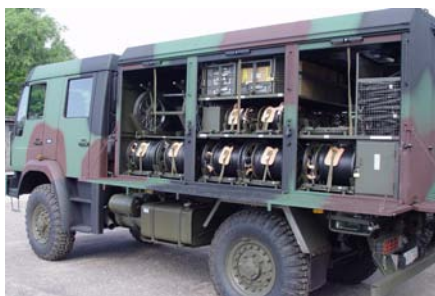
Węzłowy wóz kablowy WWK-10C
